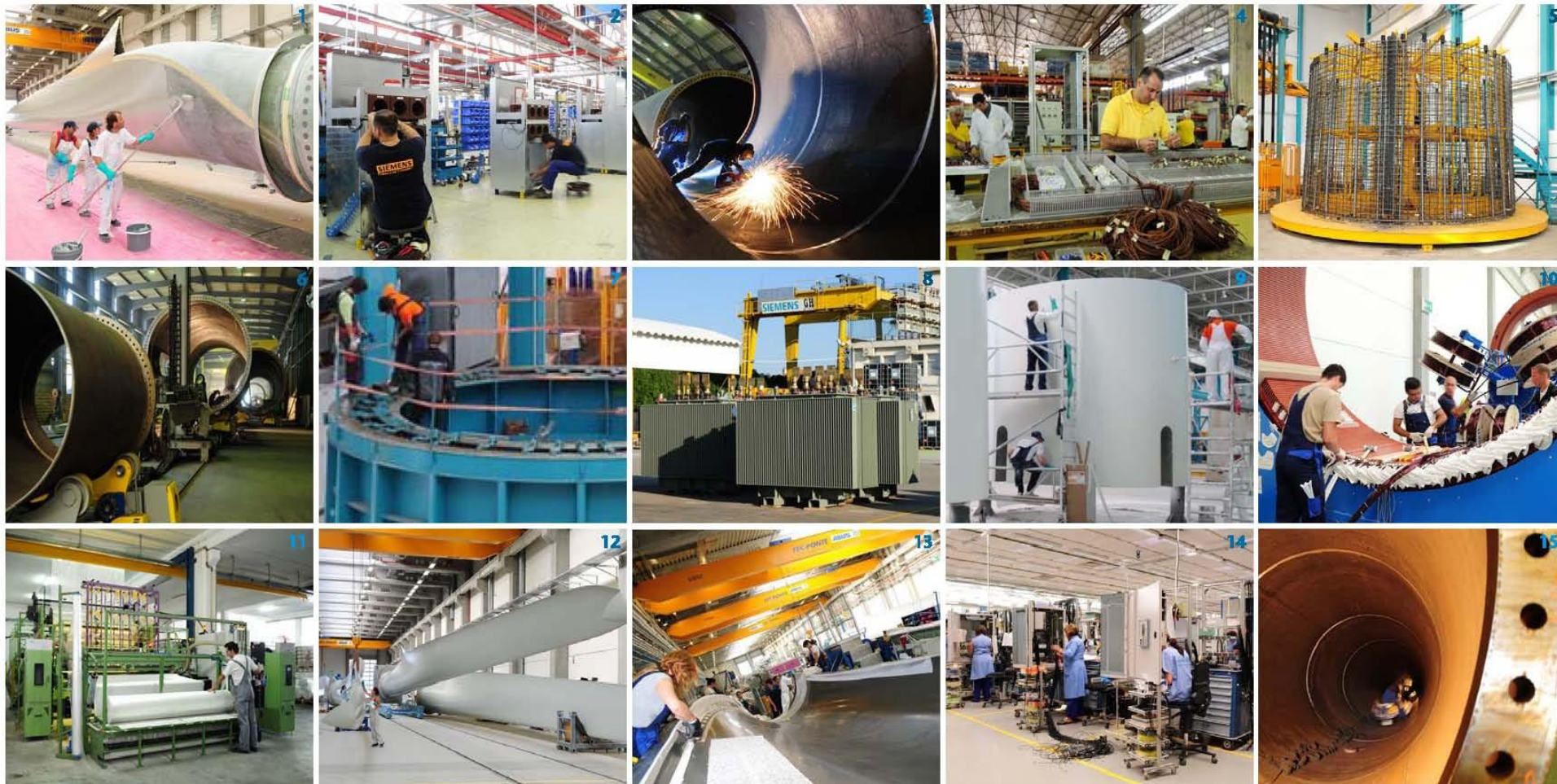
ENERCON Pás de Rotor (1, 12, 13) – ENERCON Torres de Betão (5, 7, 9) – ENERCON Geradores Síncronos (10) – SAERTEX Fibra de Vidro (11) – A. SILVA MATOS Torres de Aço (3, 6, 15) – SIEMENS Transformadores e Quadros de Média Tensão (8, 14) – JAYME DA COSTA Equipamentos Eléctricos (4)
